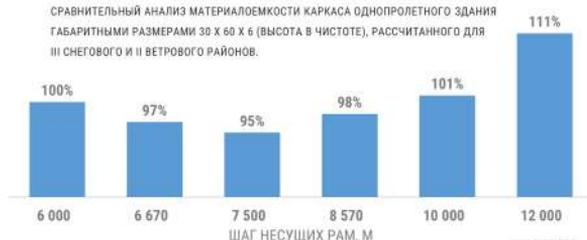
Когда мы говорим про оптимальный шаг, то имеем в виду минимальную материалоемкость конструкций. На графике видно, что для здания с габаритными размера-
